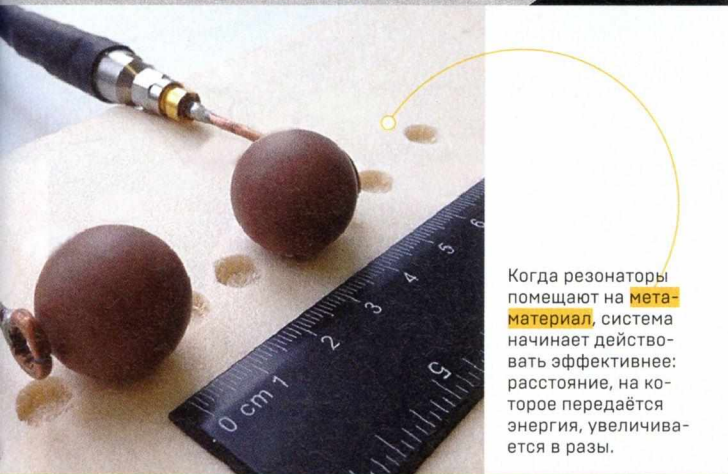
● Шарики — это керамические резонаторы . Ученые из Университета ИТМО планируют использовать их для создания беспроводных зарядных устройств.
